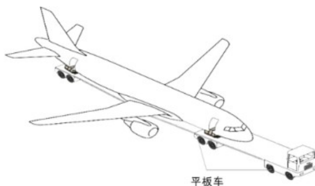
图 2 平板车使用示意
